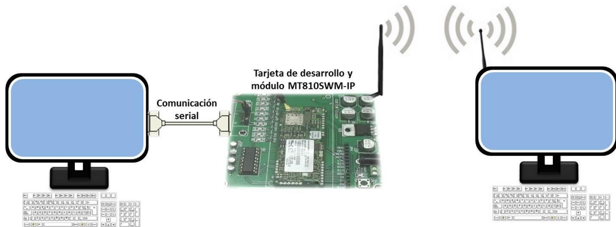
Figura 5.6. Comunicación Ad-Hoc entre tres elementos, dos computadoras y el módulo MT810SWM-IP.
