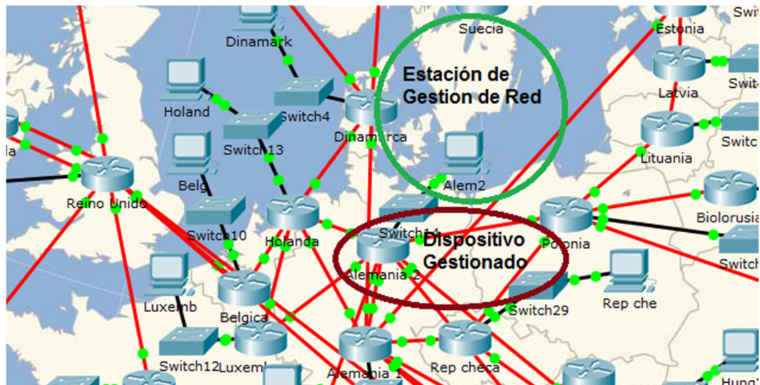
Figura 44. Dispositivo gestionado y Estación de Gestión de red.
