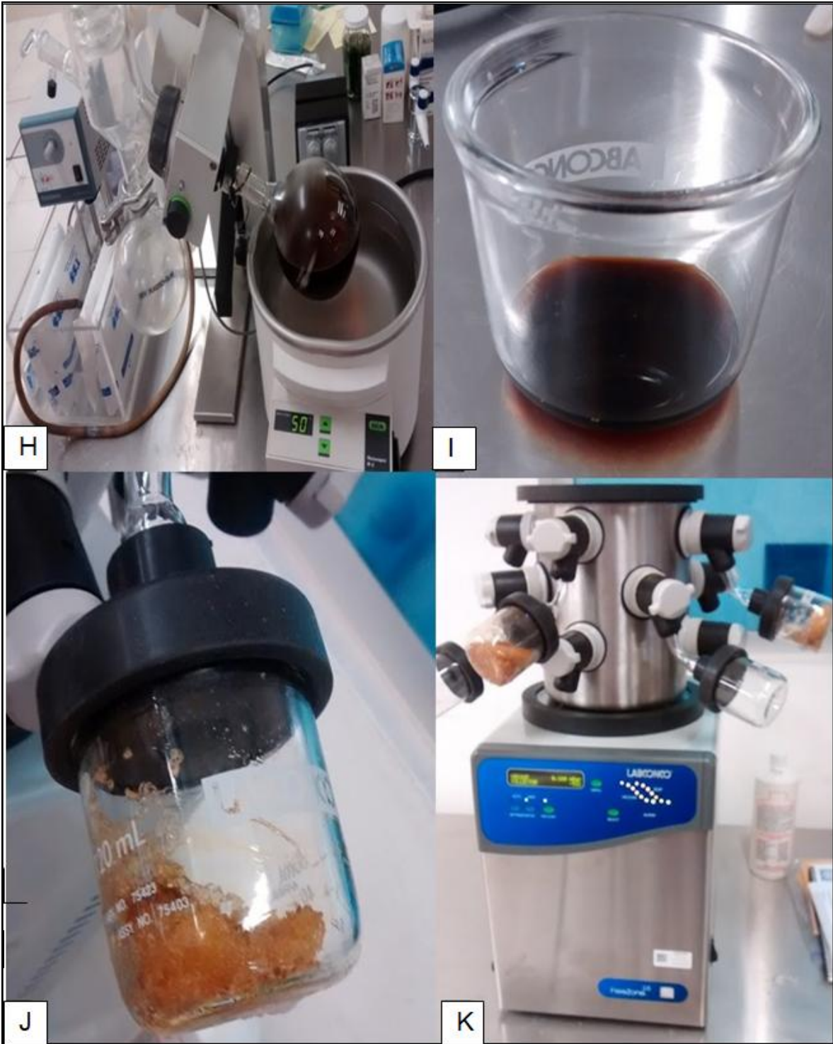
Continuación. H. Separación del solvente del extracto. I. Extracto listo para liofilizar. J y K. Proceso de liofilización (Imagen propia).
