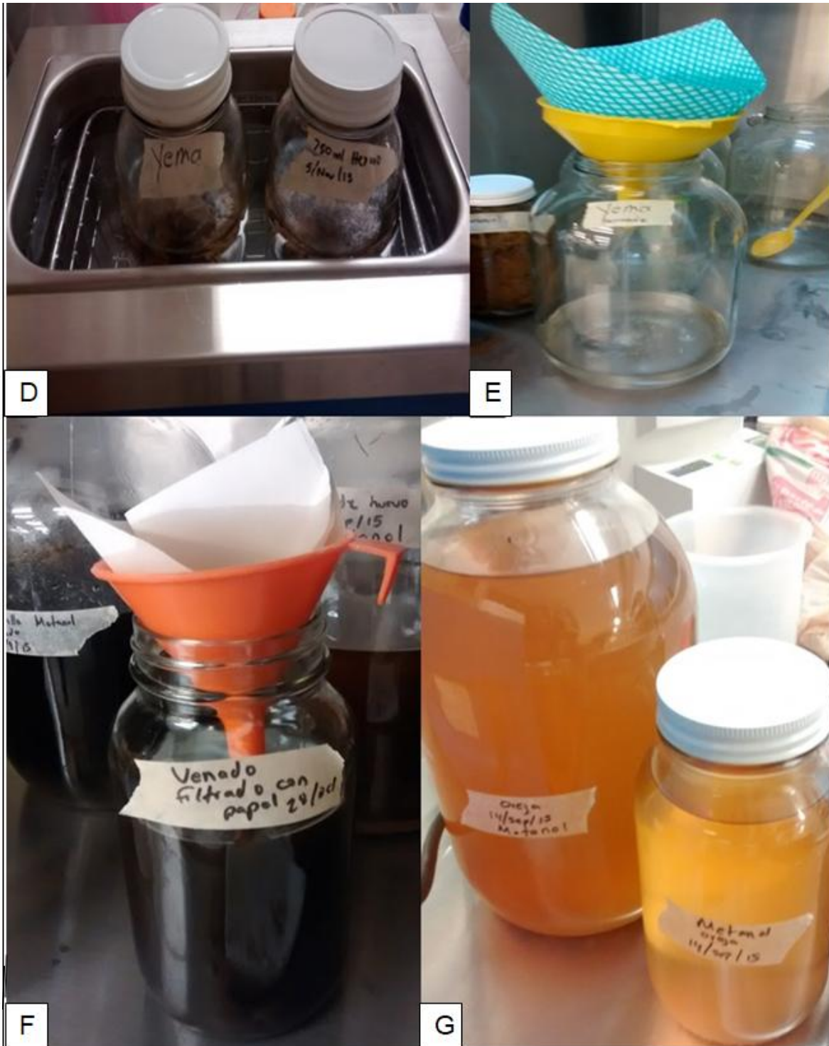
Continuación. D. Proceso de sonicado de los extractos. E y F. Separación de la biomasa por filtración. G. Extracto filtrado (Imagen propia).
