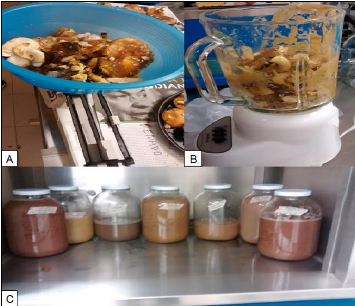
Figura 24. Proceso de obtención de los extractos. A. Peso de los hongos obtenidos en el mercado de Amecameca. B. Molienda de los hongos silvestres comestibles (licuadora). C. Maceración de la biomasa en metanol (Imagen propia).
