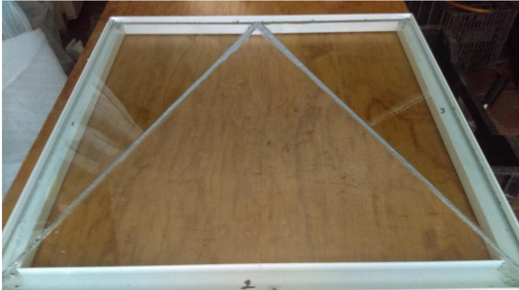
Fotografía 7 Destilador solar de pirámide, sobre canaleta de aluminio sellado con silicón para alta temperatura.
