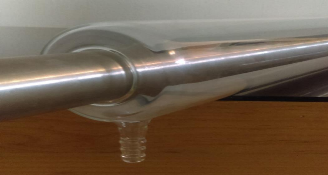
Fotografía 5 Destilador solar tubular, absorbedor y evaporador con salida para condensado.
