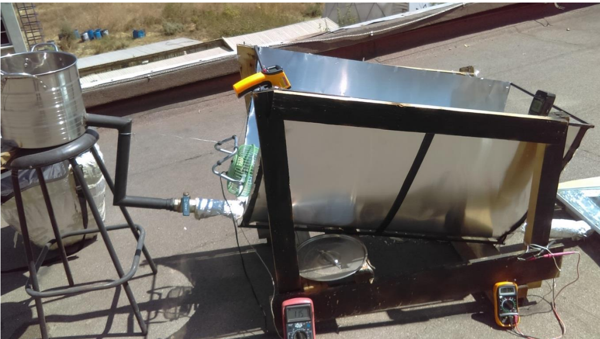
Fotografía 10 Vista del evaporador solar y los instrumentos de medición empleados.
