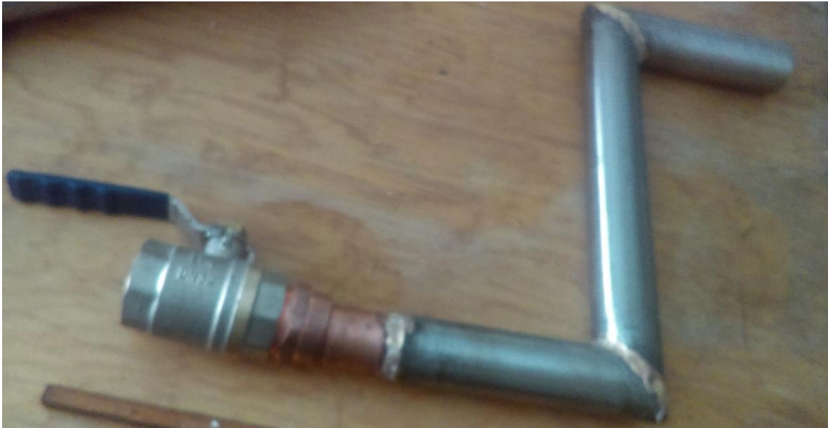
Fotografía 3 Válvula de esfera y tubo de acero inoxidable unido con soldadura de plata
