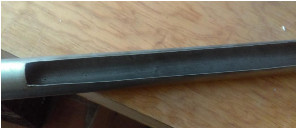
Fotografía 4 Ranura en el tubo de acero inoxidable para formación del canal
