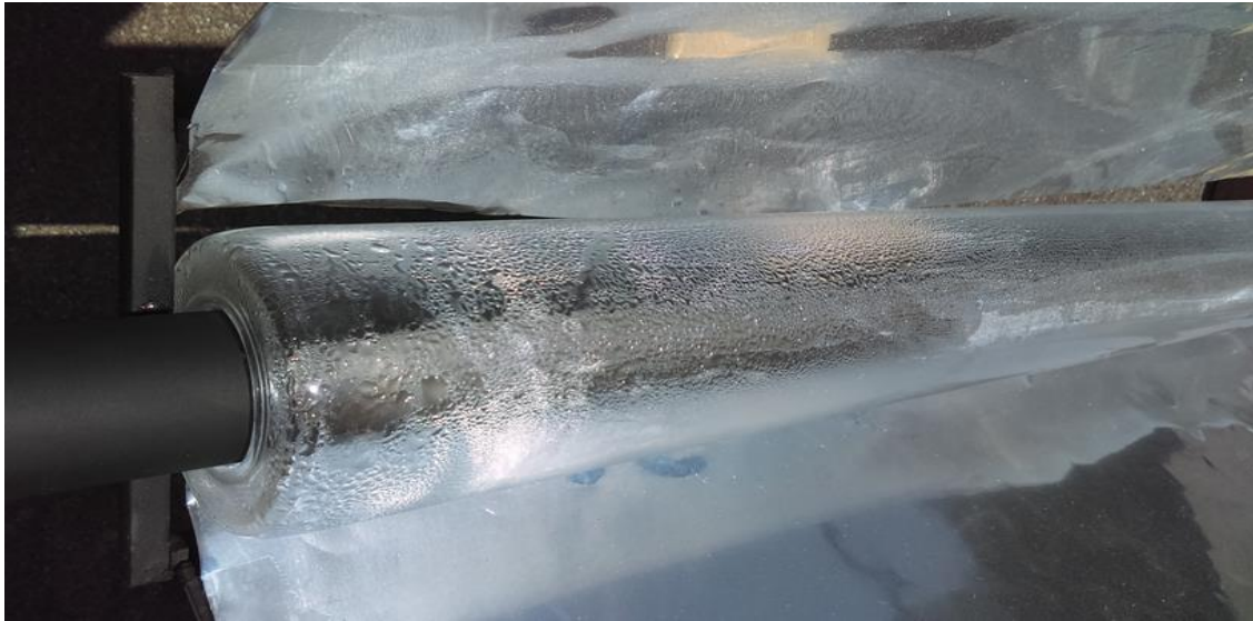
Fotografía 18 Formación de condensado sobre la pared interior del tubo de borosilicato
