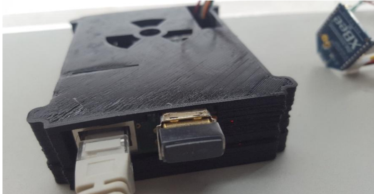
Ilustración 19 Raspberry con tarjeta de red inalámbrica y conexión con cable UTP
