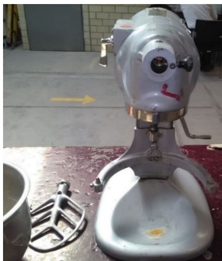
Figura 3.18. Mezcladora de morteros, propiedad de la ESIA unidad Zacatenco.
