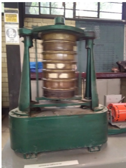
Figura 3.10. Agitador de tamices de la ESIA unidad Zacatenco Fuente: Elaboración propia
