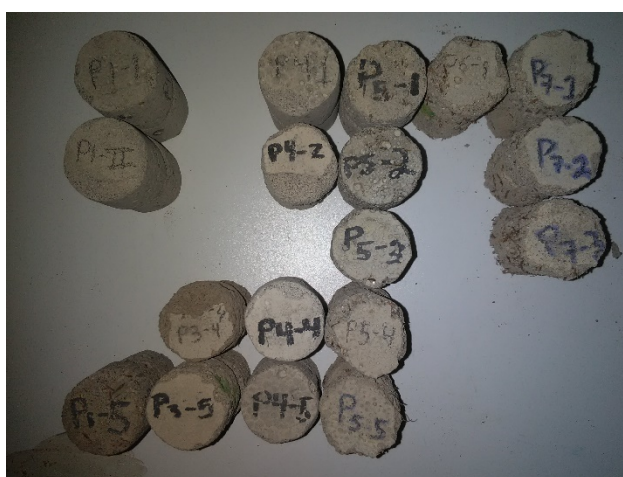
Figura 3.35. Cilindros de prueba obtenidos de placas de prueba Fuente: Elaboración propia
