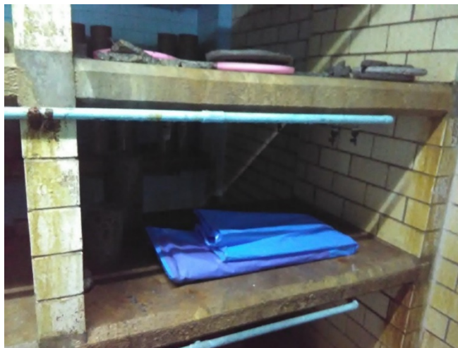
Figura 3.20. Placas en proceso de fraguado Fuente: Elaboración propia
