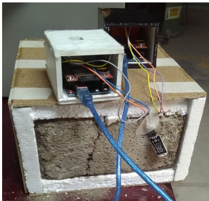
Figura 3.26. Placa de prueba instalada en caja aislada de prueba Fuente: Elaboración propia
