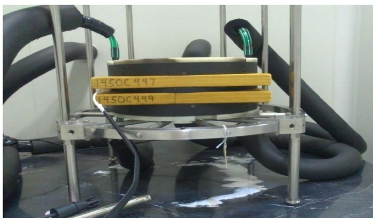
Figura 3.37. Aparato para medir la conductividad térmica de materiales sólidos aislantes Fuente: Elaboración propia
