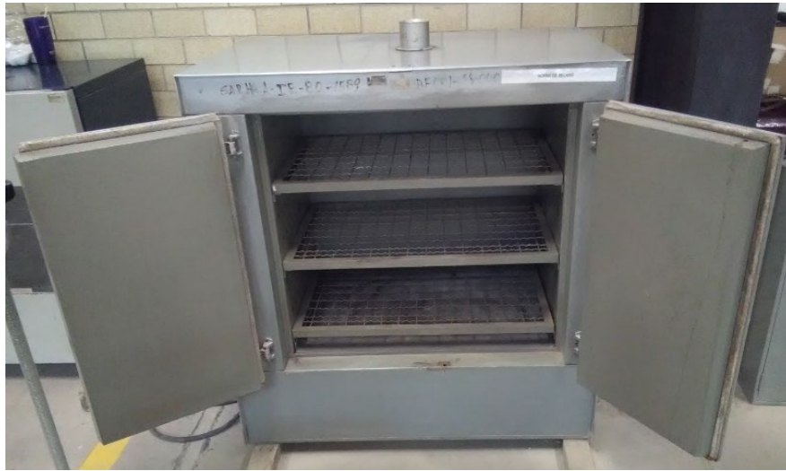
Figura 3.21. Horno de secado Fuente: Elaboración propia
