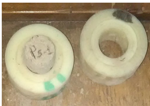
Figura 3.34. Cilindros de Nylamid fabricados en el taller de máquinas y herramientas del CECATI No.1 Fuente: Elaboración propia.
