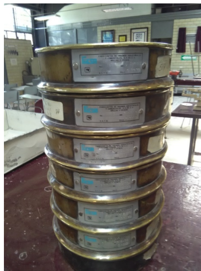
Figura 3.11. Torre de tamices de diferente medida Fuente: Elaboración propia
