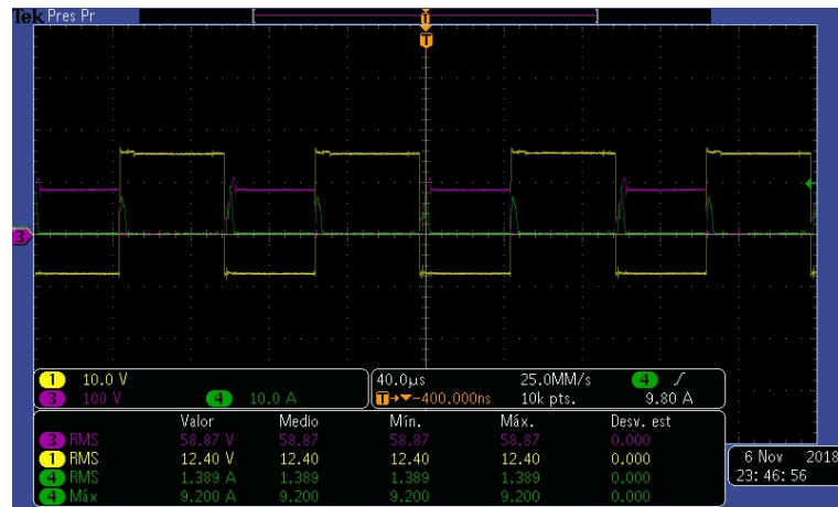
Figura 4.8: Prueba a 30 % de amplitud y frecuencia de 30hz
