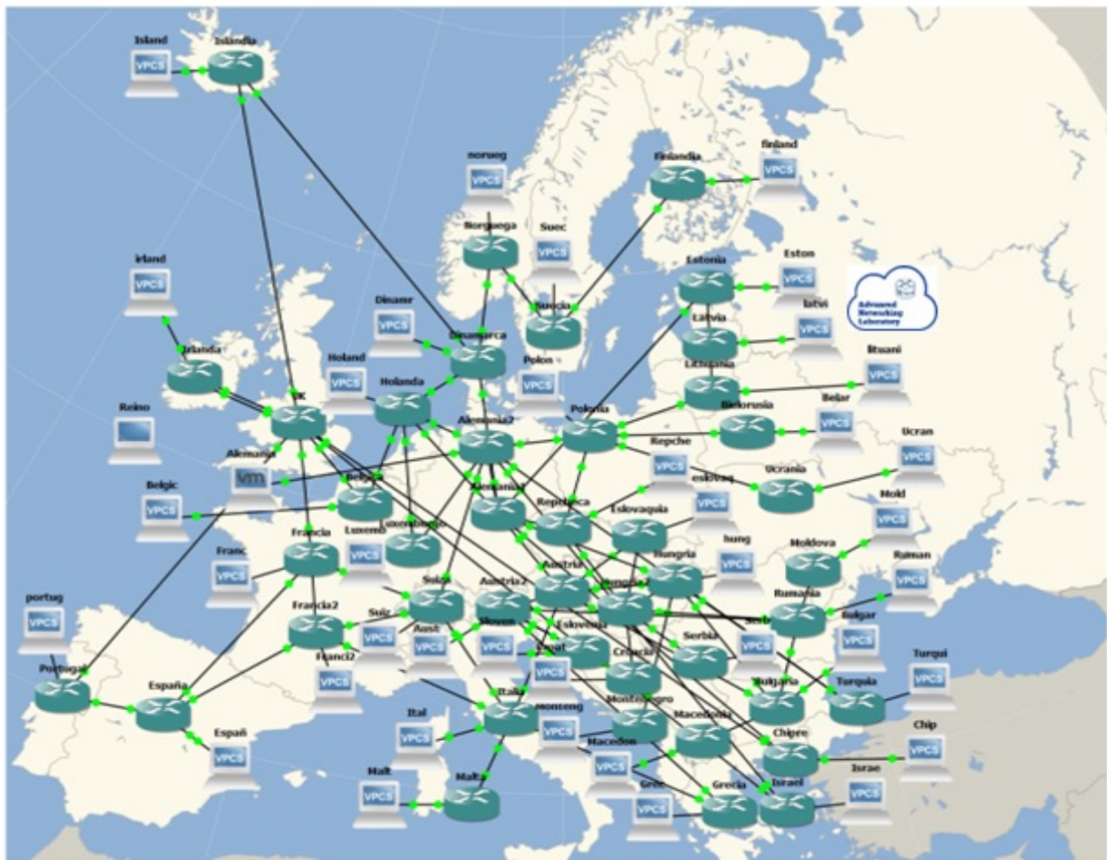
Fig. VII.11. Emulación de la topología del backbone de GEANT con 43 routers de backbone .
