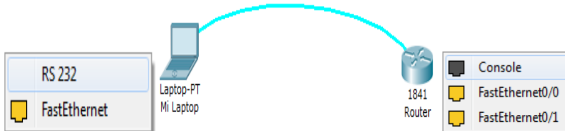
Fig. III.7. Conexión de PC a consola vía cable de consola.
