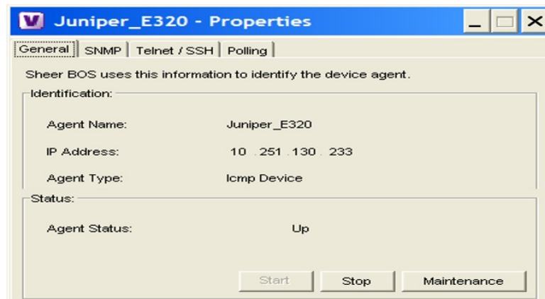
Fig. VI.7 Interfaz gráfica que muestra los generales de un agente SNMP en un router Juniper.
