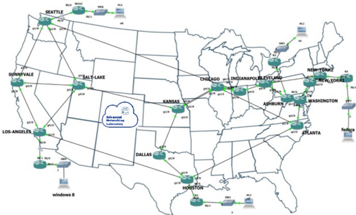
Fig. VII.3. Emulación de la topología del backbone de Internet 2 con GNS3.
