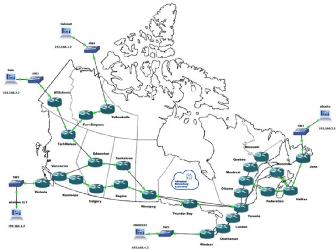
Fig. VII.4. Emulación de la topología del backbone de CANARIE con GNS3.
