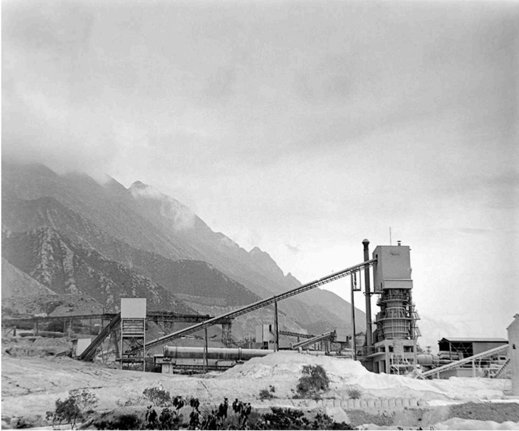
Figura 8: Ruiz, O. Y Ramonetti, A. (2020). Pedrera San Ángel, aún en funcionamiento al extremo poniente del cerro de las Mitras. Puede apreciarse el dispositivo de extracción de la roca caliza, las trituradoras y tolvas para convertirlas en arena fina, 2020.
