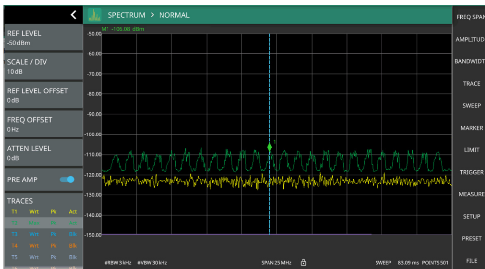
Figura 4.7.1: Nivel de potencia del espectro de la señal interferente medido en el sitio A.
