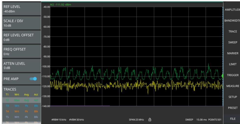
Figura 4.7.2: Nivel de potencia del espectro de la señal interferente medido en el sitio B.
