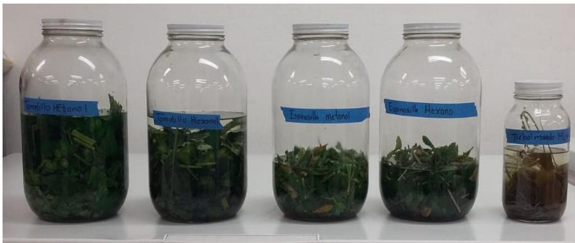
Figura 24. Frasco con el material vegetal y solvente en maceración.
