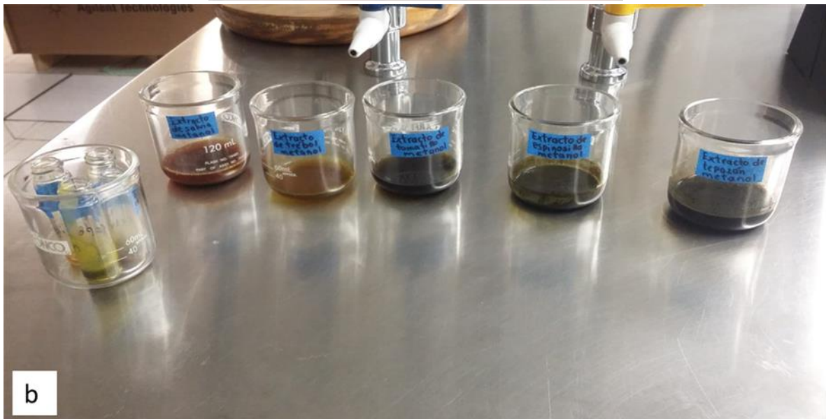
Figura 28. (a) Extractos de hexano en el horno. (b) Extractos metanólicos listos para la liofilización.
