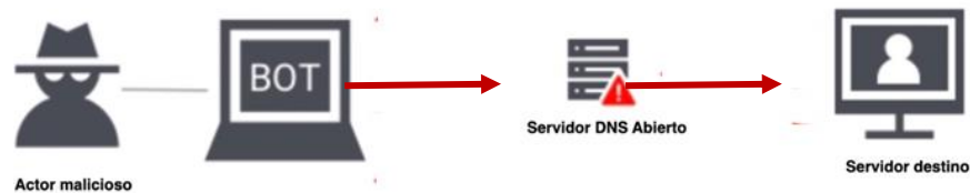
Figura 9. Ejemplo de un ataque DDoS imagen tomada de [34]
