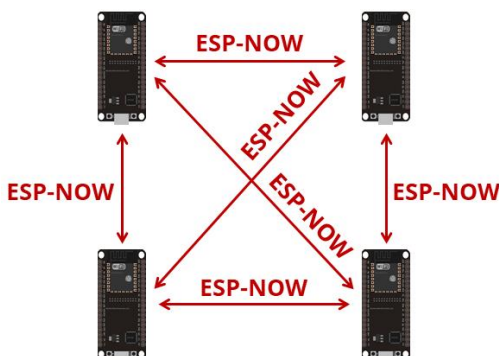
3.2: Figura N°19. Comunicación multidireccional. (Tomada de [21])
