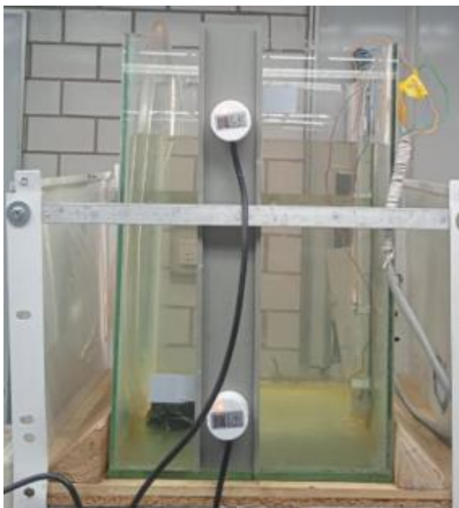
4.3: Figura N°35b. Foto a los sensores externos, funcionando en el prototipo.
