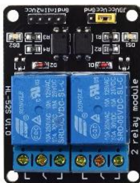
2.2: Figura N°5. Modulo relevador electrónico de 2 canales. (Tomada de [8])
