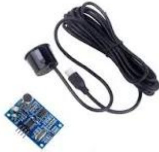
Figura N°41. Sensor ultrasónico resistente al agua. (Tomada de [24])
