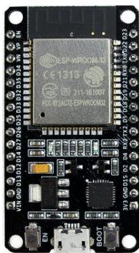
2.2: Figura N°4. Tarjeta de desarrollo ESP32 de 30 pines. (Tomada de [7])
