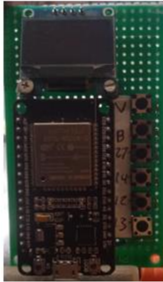
4.2: Figura N°34. Foto del Control Remoto con pantalla OLED.
