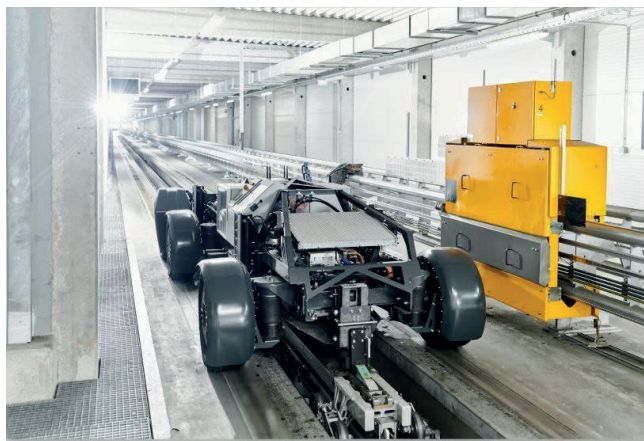
Figura 5.7: Vehículo analítico AIBA para ensayo de frenado de Continental
