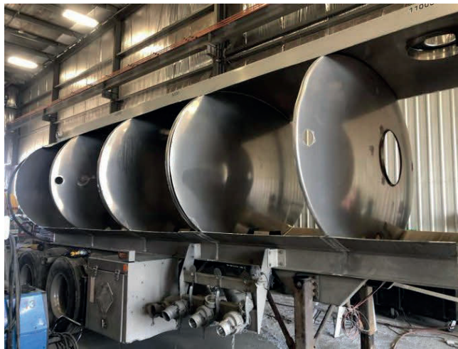
Figura 2.10: Interior de un camión cisterna (López, 2013)
