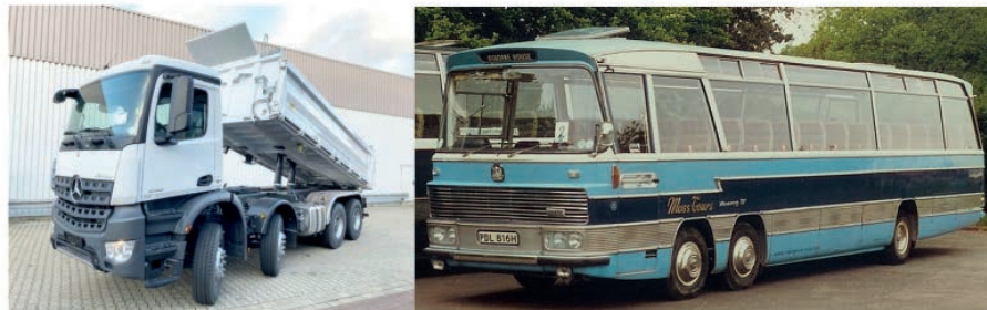
Figura 1.10: Vehículos con dos o más ejes direccionales
