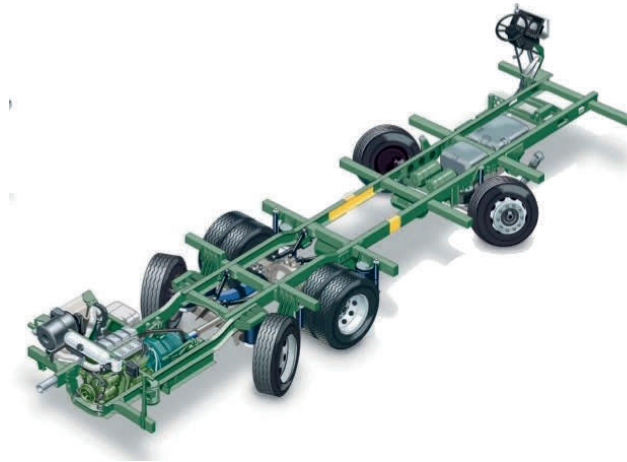
Figura 1.12: Ejemplo de un 3er eje direccional en un autobús Scania. (Scania AB, 2005)
