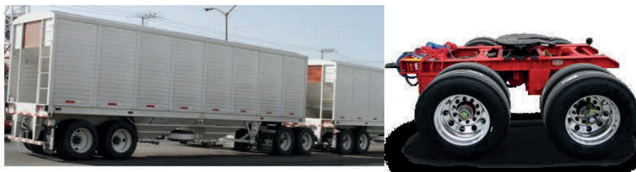
Figura 1.16: Ejemplo de semirremolque con acoplamiento para ser remolcado
