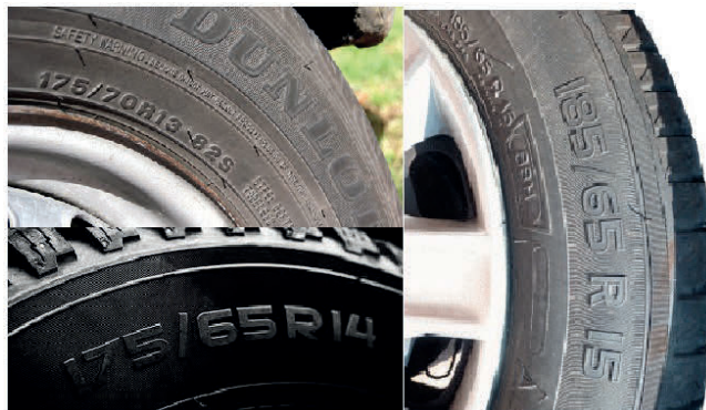
Figura 1.3: Neumáticos con códigos de características
