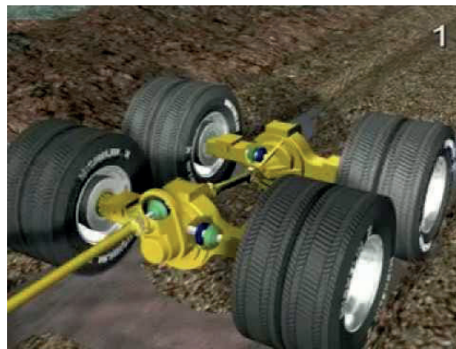
Figura 1.8: Eje torton. Nótese un calabazo en cada eje
