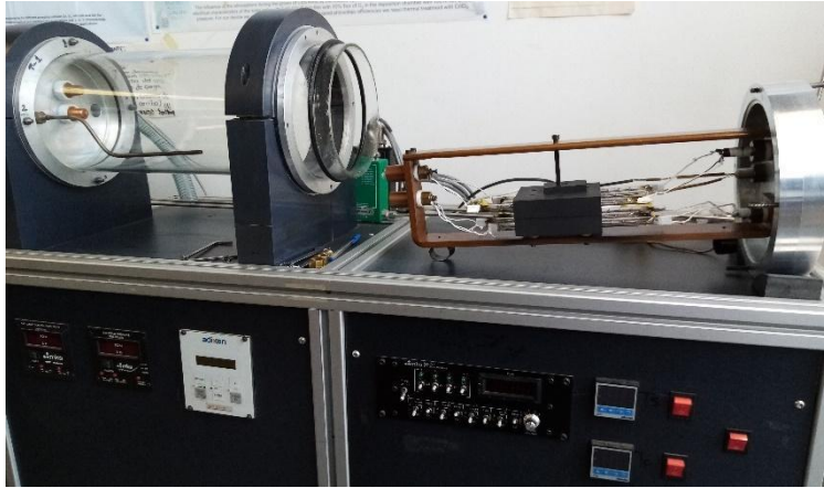
Figura 19. Sistema de transporte de vapor en espacio cercano.
