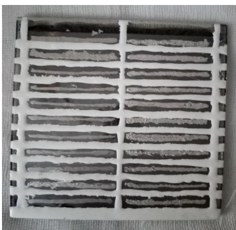
Figura 26. Aislamiento del módulo fotovoltaico mediante la utilización de tinta policat.
