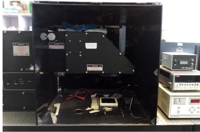
Figura 31. Simulador solar Oriel certificado clase AAA.
