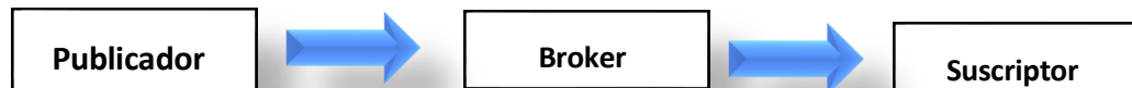
Figura 4 Funcionamiento del bróker, autoría propia basada en Goto IoT | Introducción a MQTT. (s. f.). https://www.gotoiot.com/pages/articles/mqtt_intro/index.html
