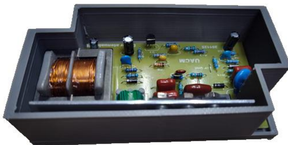
Figura 5.72 Driver en caja prototipo reverso.
