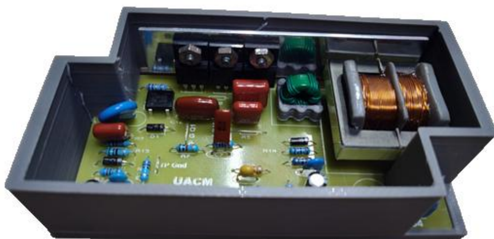
Figura 5.71 Driver en caja prototipo frontal.
