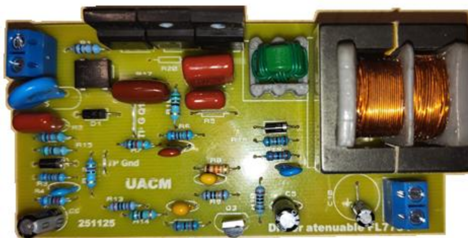
Figura 5.70 Driver, montaje de componentes.
