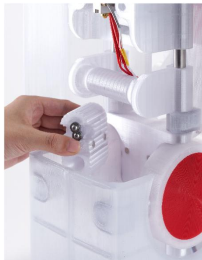
Figura 2.6 Cortador dentro del Polyformer.
