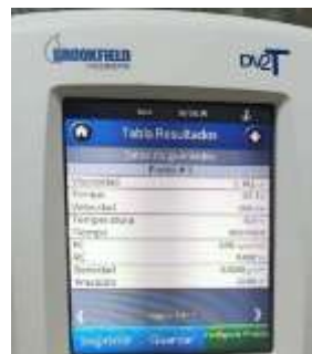
C: Velocidad de rotación 200 rpm con un torque aceptable del 57%
