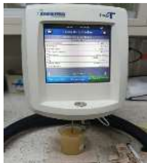
A: Viscosímetro con aguja RV3
