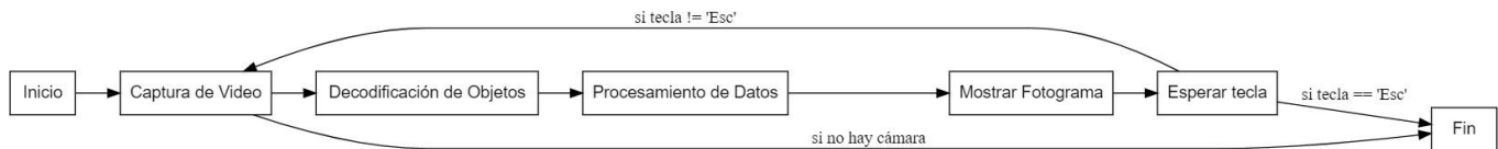
Figura 20. Diagrama a bloques del proceso de captura y reconocimiento de QR.
