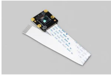
Fig. 16. Cámara Module 2 NoIR de Raspberry™ seleccionada. Tomado de Raspberry Pi Camera V2 Noir, por TannaTechBiz, (s. f). https://tannatechbiz.com/raspberry-pi-camera-v2-noir.html
