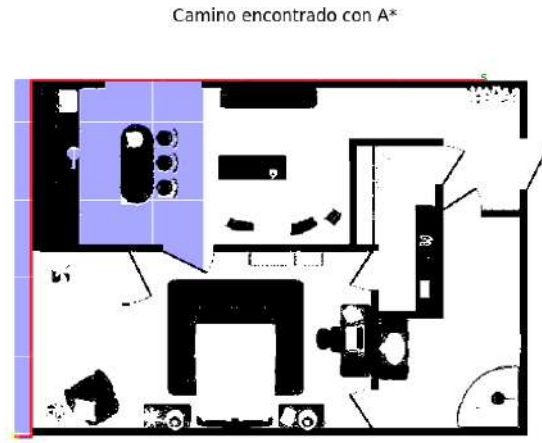
Figura 2.5: Visualización unificada del algoritmo A* sobre un entorno generado a partir de una imagen binarizada. El camino encontrado está marcado en rojo, los nodos explorados en azul claro, y los obstáculos en negro, todo presentado a tamaño real para facilitar la interpretación.
