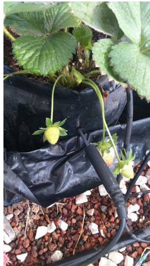
Figura 5.13: Sonda de temperatura colocada en la raíz de la planta.
