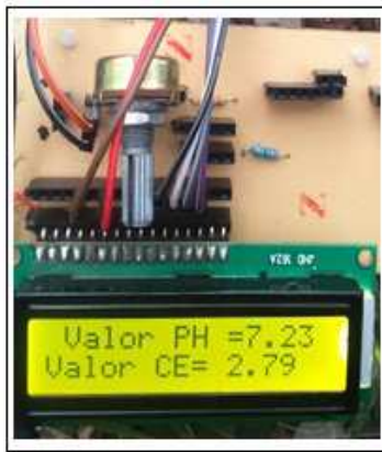
Figura 4.9: Despliegue de valores de pH y conductividad eléctrica.
