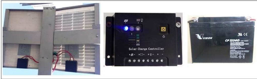
Figura 3.10: Panel solar, controlador de carga y batería de 12 Volts .
